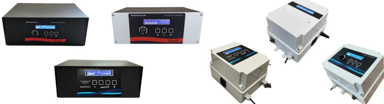
Il generatore da banco è la soluzione di controllo ultrasuoni per chi desidera un generatore indipendente dalla vasca, completo ed immediato. Tutto quello che il costruttore della vasca dovrà fare sarà collegare al generatore il gruppo trasduttori (operanti nella banda 22-60 kHz) e alimentare il sistema (230 Vac, 50/60 Hz). Sono disponibili sei versioni, in base alla potenza richiesta :
