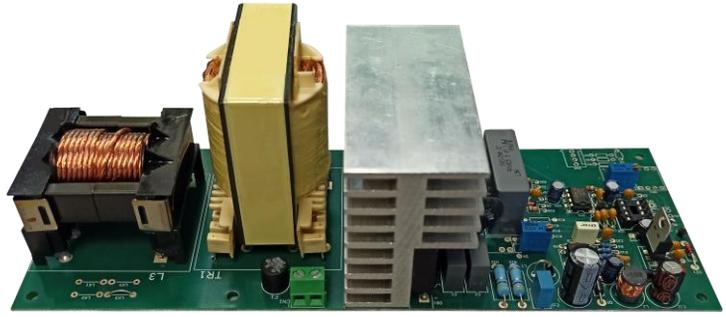
Le nostre due schede di potenza sono disponibili anche nella versione a giorno, per i costruttori di vasche che vogliono provvedere autonomamente alla disposizione della scheda all'interno della loro applicazione, garantendole l'adeguata ventilazione.
